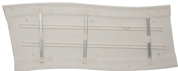
Face intérieure du moulage faisant apparaître les renforts métalliques de type F530 qui pourront être utilisés pour la fixation au plafond de la vague.
